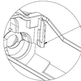
**Brückenklemme Zugentlastung** kann zur einfacheren Montage im Gehäuseunterteil eingerastet werden. Zur Demontage sind mit einem Schlitzschraubendreher die seitlichen Laschen zu betätigen.
